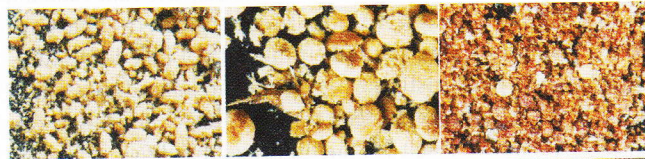
Mööbli-toonesepa ( Anobium punctatum (De Geer)) näripuru 50x suurenduses Raudsepa ( Xestobium rufovillosum (De Geer)) näripuru 40x suurenduses Häälletu toonesepa ( Ernobius mollis (L.)) 30x suurenduses
